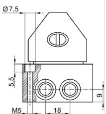
1) Max. Pos. 0: port 1 ► port 4, port 2 ► port 3 pos. I: port 1 ► port 2, port 4 ► port 3
